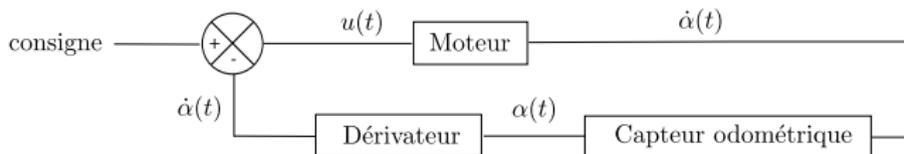
**FIGURE** – Chaîne de commande d'un moteur électrique.  $u(t)$  est la commande et  $\alpha(t)$  l'angle de rotation du moteur.
